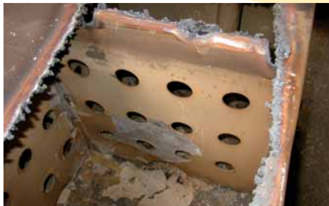
Утайки и остатъци по стените и дъното на водна цистерна — Източник: ISPESL
