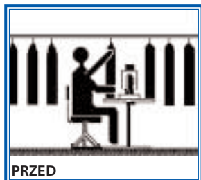
Podniesienie miejsca pracy ogranicza niewygodne unoszenie ramion przy obsłudze maszyny do szycia w fabryce ubrań.
