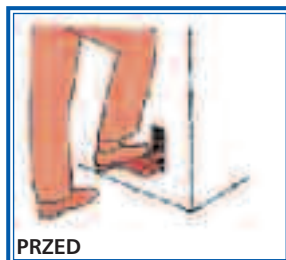
Inne zaprojektowanie pedału nożnego ogranicza siłę, którą operator maszyny musi do niego przyłożyć.
