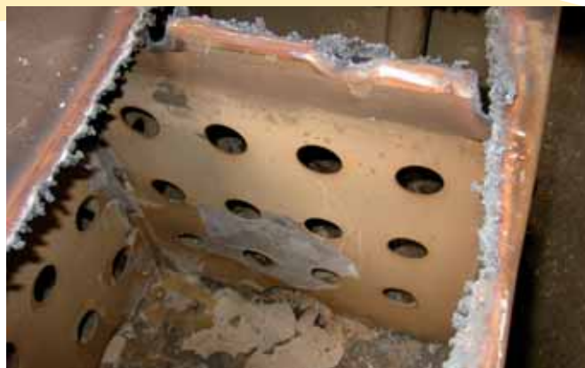
Üledék és törmelék a víztartály falain és alján – Forrás: ISPESL
