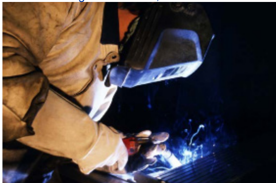
2. attēls: Metināšanas aerosolā ir kairinošas gāzes un tvaiki, kā arī smalkas mikrodaļiņas, HVBG/Senn
