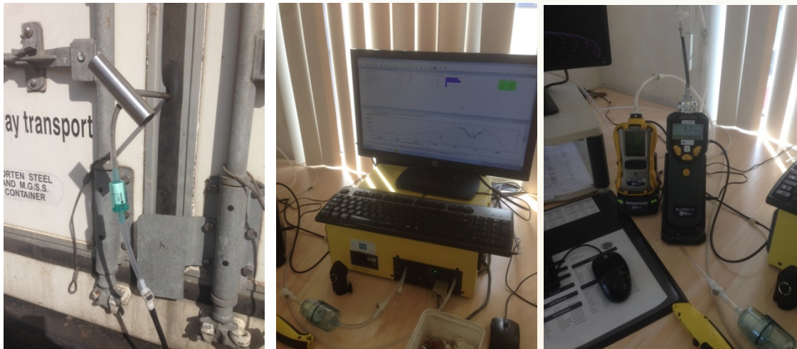
Abbildung 3: Containerluft wird durch die zwischen die Gummidichtungen der Containertüren geschobene Düse über einen Schlauch zu Überwachungsgeräten geleitet.
