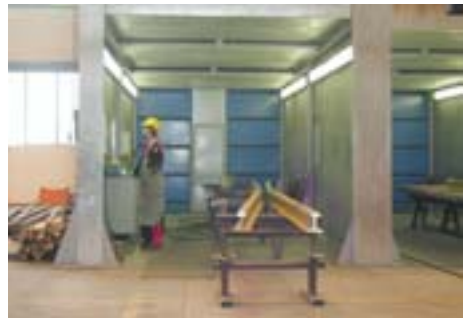
Nachher: Schleifkabinen für das Schleifen von Herzstücken
