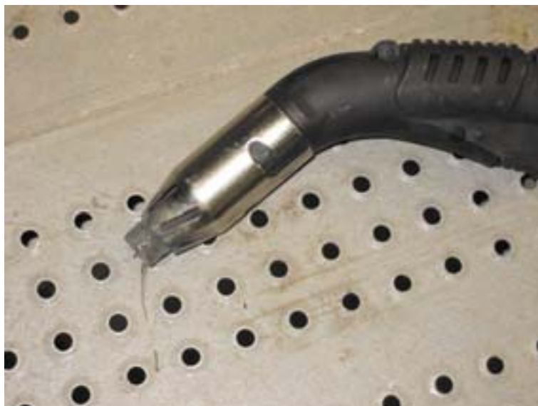
Integrierte Absaugvorrichtung an MIG-Schweißpistole
