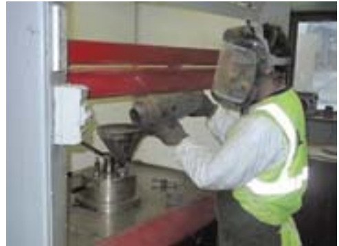
Das bisherige Verfahren: Ein Arbeiter gießt Bitumen und Methylchloridlösung in die Vakuumpumpe. Der Methylchloridabfall wird anschließend in einen Behälter unter dem Rauchabzug entleert.
