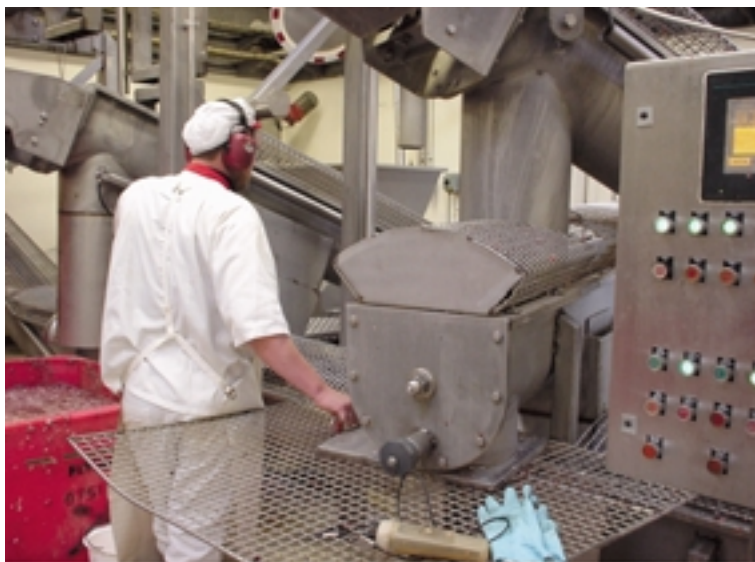
Employee at the screw conveyors, which are covered by mesh to prevent accidents. Medarbejder ved sneglene, som er dækket med net for at forebygge ulykker.
