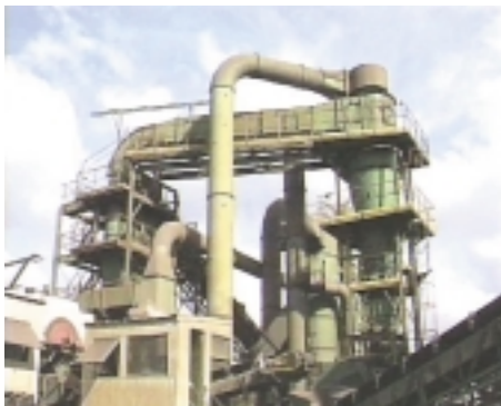
Esempio di dispositivo di pulizia e aspirazione delle polveri cofinanziato da una CRAM in un centro di demolizione per la ripulitura ed il riciclaggio di metalli.
