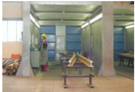
Après: cabines de meulage des cœurs d'aiguillage.
