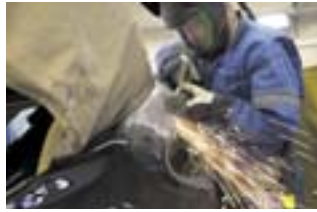
Avant: rectification croisée sans dispositif d'extraction intégré.
