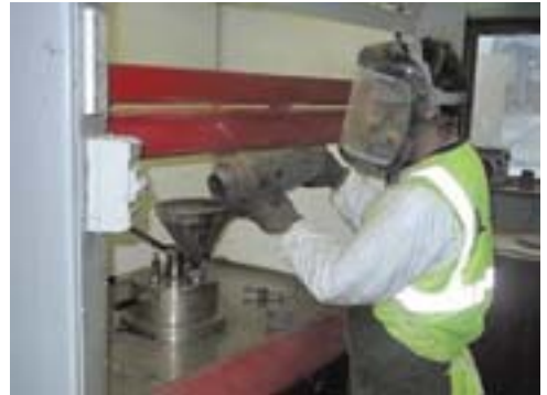
Ancienne méthode de contrôle: le salarié verse du bitume et une solution de chlorure de méthylène dans la pompe à vide. Les résidus de chlorure de méthylène sont ensuite déversés dans un récipient sous la hotte de laboratoire.
