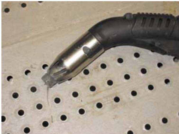
Extracteur intégré au pistolet de soudage MIG.
