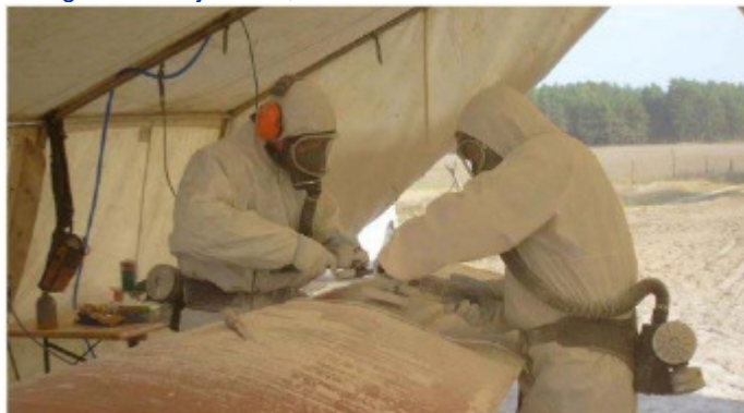
1. ábra: Szélgenerátorok hengerlésének javítása, KOOP
