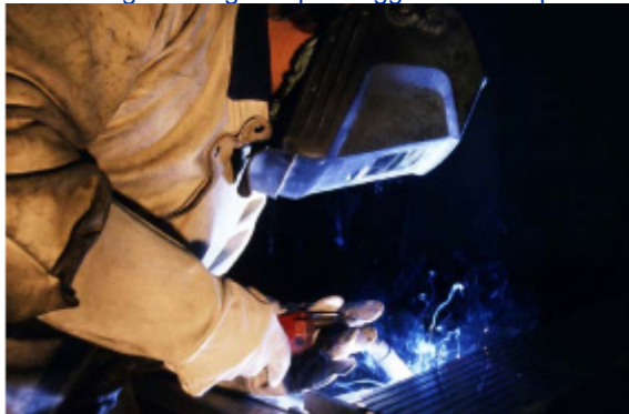
Figur 2: Sveiserøyk inneholder irritative gasser og damp i tillegg til ultrafine partikler, HVBG/Senn
