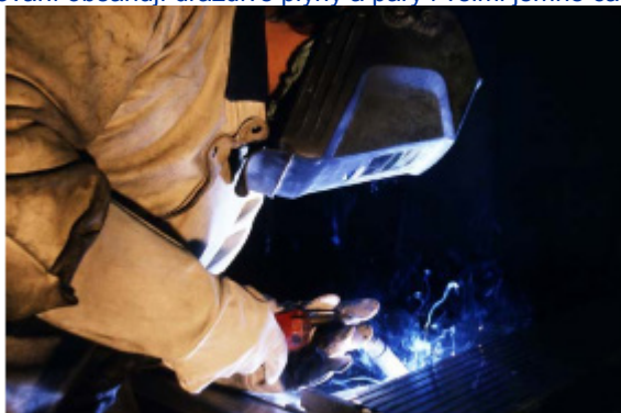
Obrázek č. 2: Výpary ze svařování obsahují dráždivé plyny a páry i velmi jemné částice, HVBG/Senn
