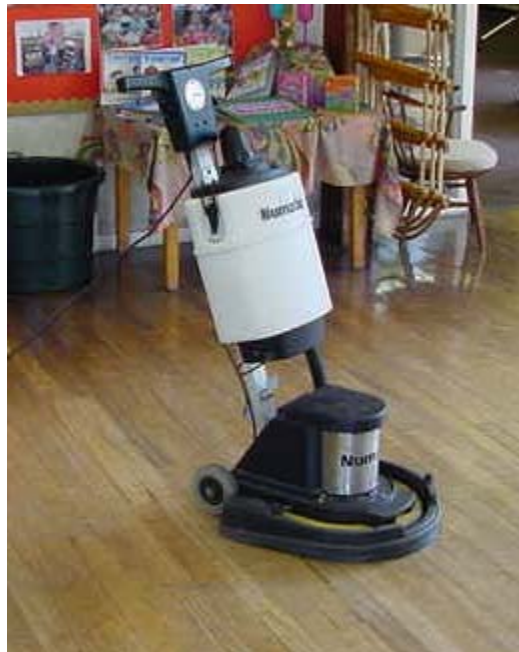
Slika 2: običajni stroj za loščenje z vrtljivo krtačo
