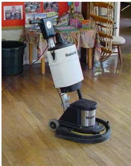
Фигура 2: Снимка на типична полираща машина с въртящ се диск
