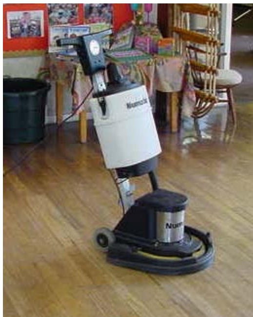
Figura 2: Fotografia de uma polidora rotativa normal
