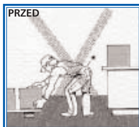
Zmiana wysokości pracy wyeliminowała potrzebę pochylania się pracownika podczas rozładunku.
