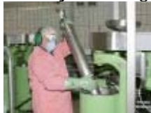
Fig. 1: Verwijderen van de rotor met een hefinstrument dat aan het plafond is bevestigd
