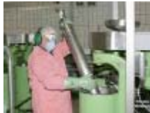
1 pav. Rotorius ištraukiamas prie lubų pritvirtintu kėlikliu.
