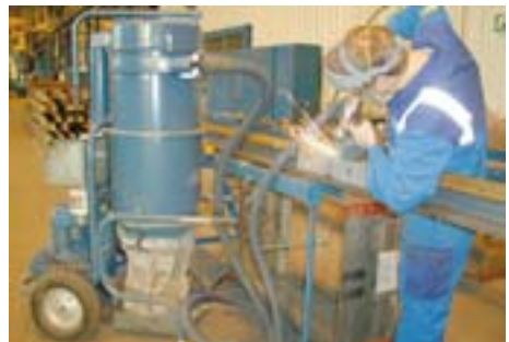
Après: ventilateur par extraction locale pour le meulage des joints de rail isolants.
