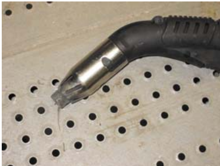
Extracteur intégré au pistolet de soudage MIG.
