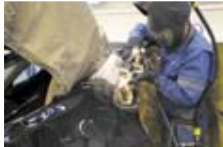
Après: rectification croisée avec dispositif d'extraction intégré.
