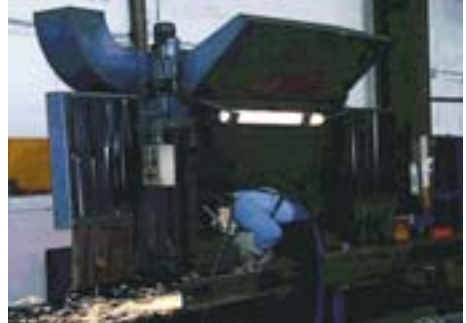
Avant: meulage des cœurs d'aiguillage.
