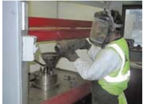
Ancienne méthode de contrôle: le salarié verse du bitume et une solution de chlorure de méthylène dans la pompe à vide. Les résidus de chlorure de méthylène sont ensuite déversés dans un récipient sous la hotte de laboratoire.
