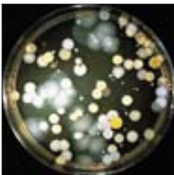
Moississure sur un filtre d'évacuation d'air (Berufsgenossenschaftliches Institut für Arbeitsschutz, Allemagne)
