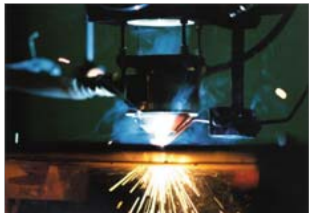
Traitement de matière au moyen d'un rayon laser produisant des particules ultrafines (Berufsgenossenschaftliches Institut für Arbeitsschutz, Allemagne)
