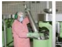
Fig. 1: extraction du rotor à l'aide d'un instrument de levage monté au plafond
