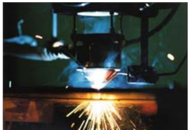
Material processing with laser beam creating ultrafine particles, Berufsgenossenschaftliches Institut für Arbeitsschutz, Germany
