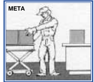
Η αλλαγή του ύψους της θέσης εργασίας περιορίζει τη σκυφτή στάση κατά την εκφόρτωση.
