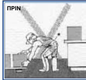
Η αλλαγή του ύψους της θέσης εργασίας περιορίζει τη σκυφτή στάση κατά την εκφόρτωση.
