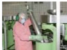
Εικ. 1: Έλξη του ρότορα με εργαλείο ανύψωσης προσαρτημένο στην οροφή
