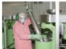
Fig. 1: Rotoren trækkes ud ved hjælp af en løfteanordning monteret i loftet.
