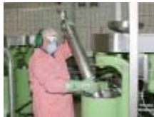
Фиг. 1: Изваждане на ротора с монтиран на тавана подемен механизъм
